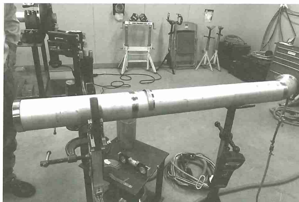
写真7 溶接前の真空管の積載状況
