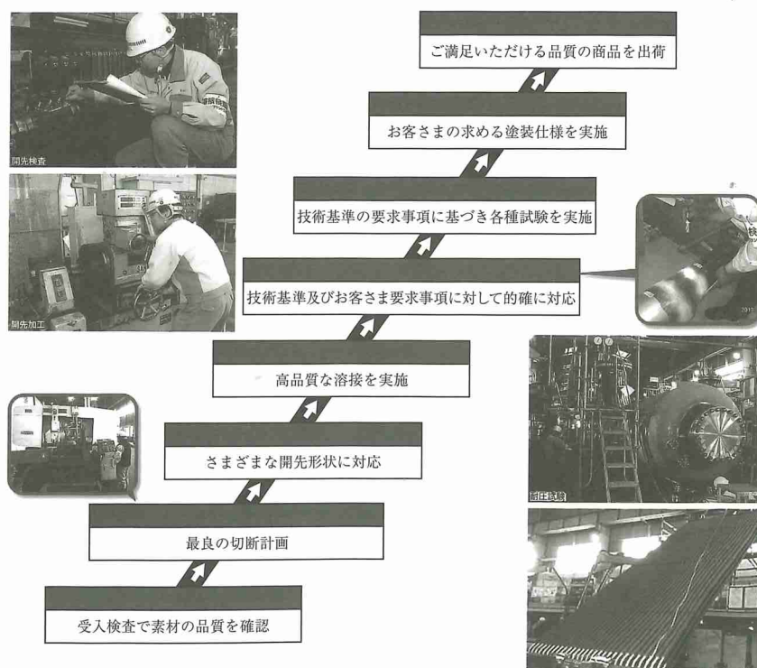
図4 配管の生産工程フロー。プロセス管理が基本
