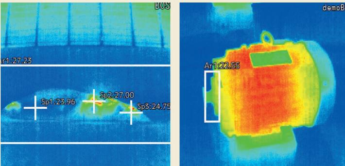
発火検知、火災防止のために燃料を監視している
